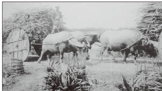
荷蘭人自中國大陸引進順服之水牛來駕石轆榨蔗取汁造糖（牛車輪是木板製成）
