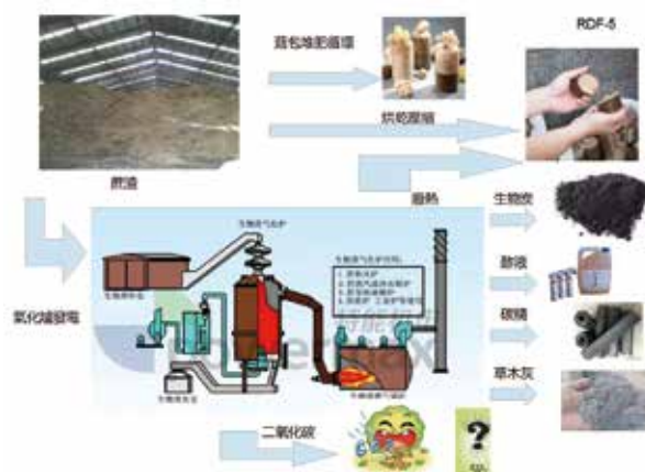
蔗渣固化技術與氣化燃燒
