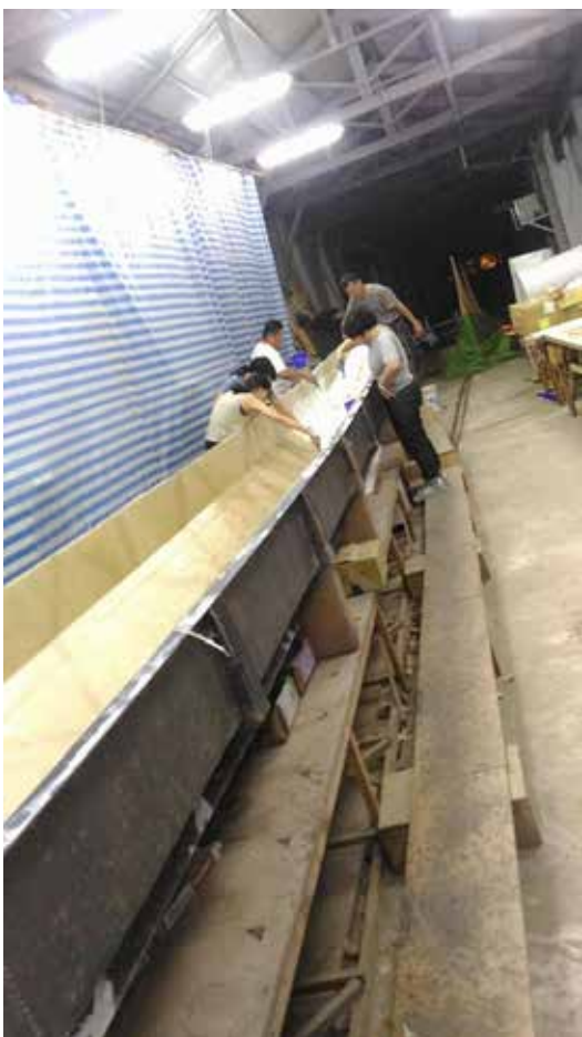
台東糖廠免費提供300坪砂糖倉庫旁之廊道作為造舟場地，由其打造一艘16公尺、名為「綠舟」的龍舟。
