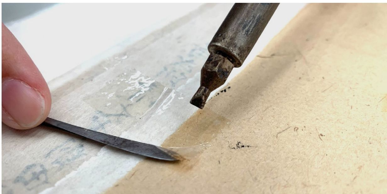
熱風筆原理為熱能軟化膠帶上的黏著劑並搭配金屬抹刀來移除（圖為感壓式膠帶）
