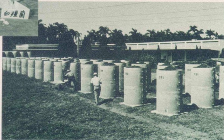
灌溉水質與土壤塩化及鹼化試驗所用之簡易滲漏計。
