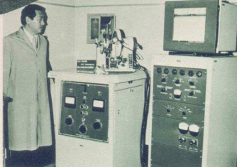
用X光繞射儀鑑定土壤粘土礦物。
