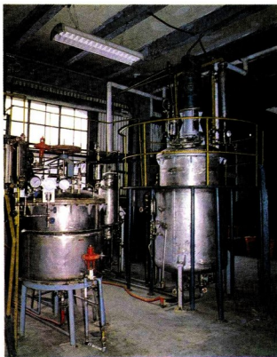
利用糖蜜為原料，以 400 及 1000 公升醱酵槽製造離胺酸，可供飼料補充物。
